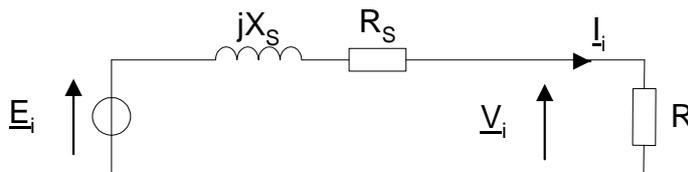
2- Sachant que la tension simple à vide de l'alternateur est  $E = 240 \text{ V}$ , calculer la valeur efficace des courants de ligne  $I$  et des tensions simples  $V$  en charge.
